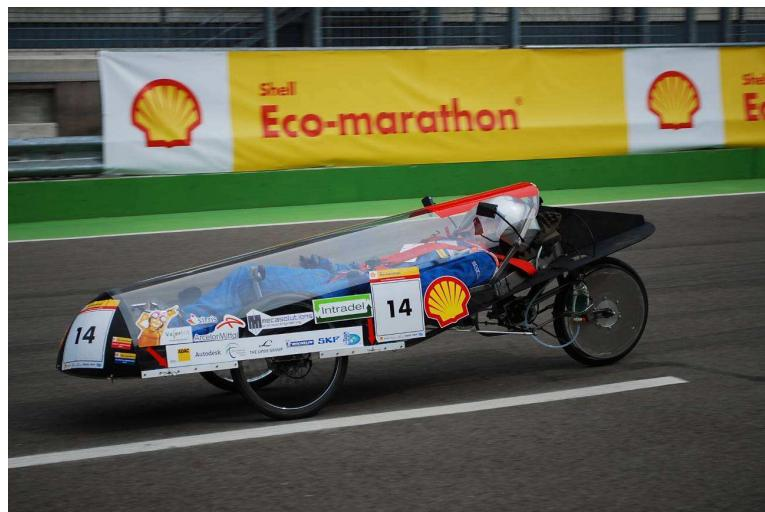
Ci-dessous le prototype réalisé par la Haute Ecole de la Province de Liège, avec de l'acier THR fabriqué à Kessales. Il a effectué 445 km avec un litre de carburant, ce qui lui a permis d'être 49<sup>e</sup> sur 116 participants de la catégorie « Protos à moteur thermique » et 9<sup>e</sup> dans la catégorie Ethanol.
